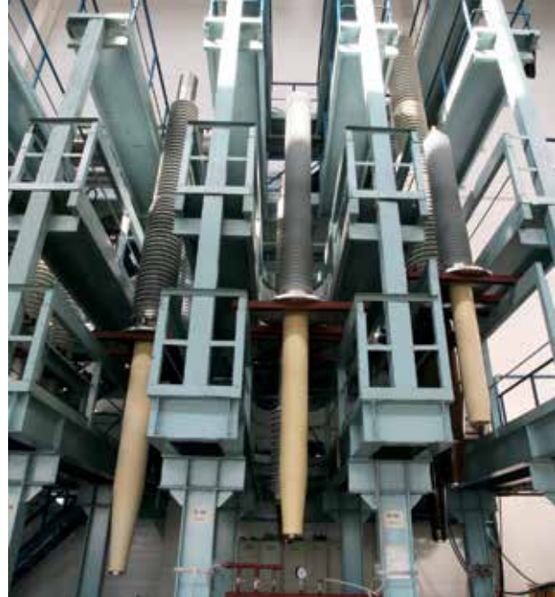
➤ Сборка вводов 220–500 кВ с особо влагостойкой RIN-изоляцией, разработанной в СКТБ
