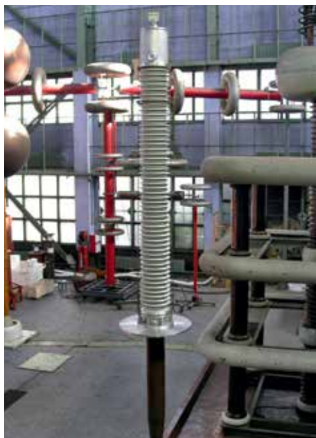
➤ Ввод 500 кВ, изготовленный в августе 2006 года по RIP-технологии и ставший 500-тысячным вводом за всю историю завода «Изолятор»
