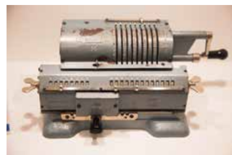
➤ Арифмометр «Феликс М» — устройство для проведения расчетов, предшествовавшее электронно-вычислительным машинам (экспонат музея группы «Изолятор»)
