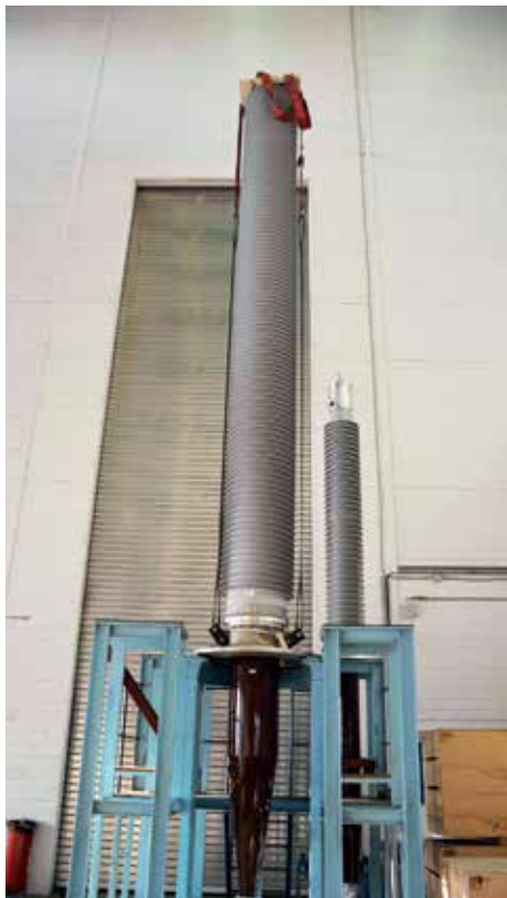
➤ Ввод 800 кВ, изготовленный для Индии
