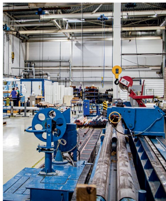
Участок намотки основной изоляции высоковольтных вводов классов напряжения до 1150 кВ включительно
