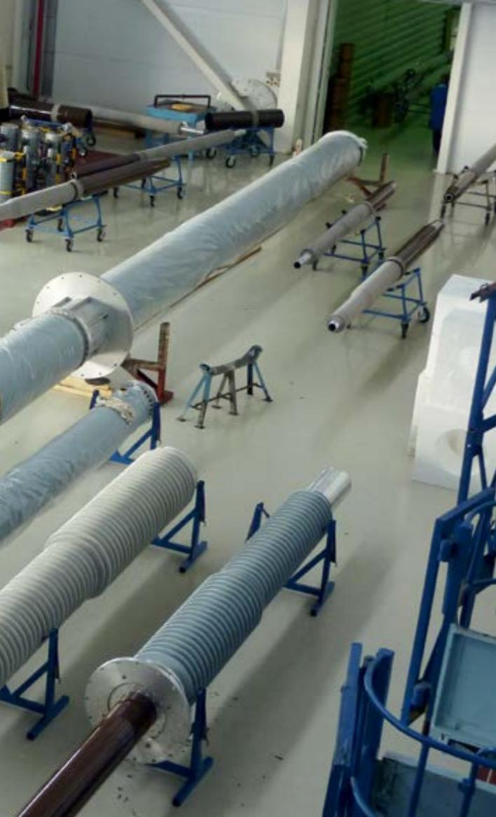
Первый в России ввод класса напряжения 1150 кВ с твердой внутренней RIP-изоляцией, созданный в производственном комплексе «Изолятор»
