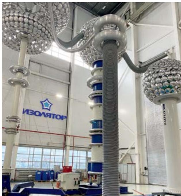
Испытания ввода на напряжение 800 кВ, изготовленного по заказу индийской государственной электросетевой компании
