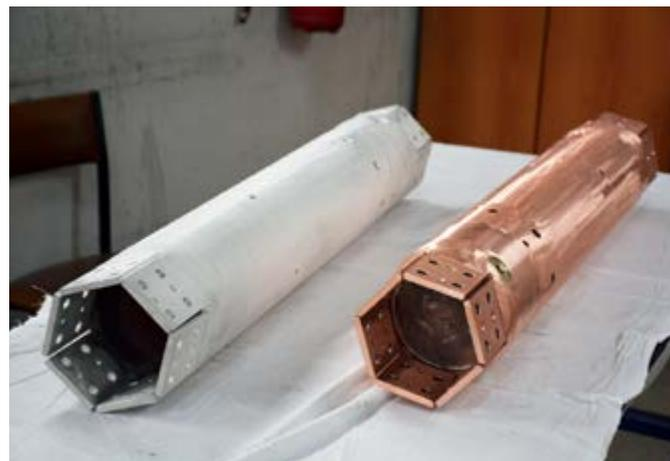
➤ Токоведущая труба съемного ввода класса напряжения 24 кВ для трансформаторов до (справа) и после оловянирования
