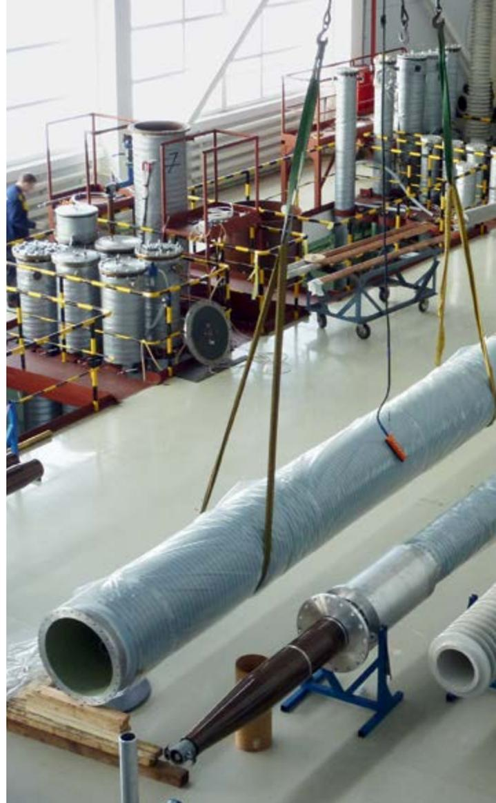
В настоящее время группа компаний «Изолятор» выпускает вводы с полым полимерным изолятором на классы напряжения от 45 до 1150 кВ включительно с твердым или газообразным наполнителем, кабельную арматуру — на классы напряжения от 110 до 500 кВ включительно с жидким наполнителем или сухой.
