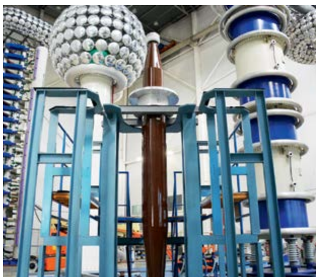
Первый в России ввод 1150 кВ с твердой внутренней RIP-изоляцией
