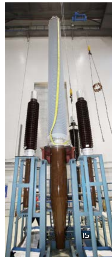
Первый в России ввод 1150 кВ с твердой внутренней RIP-изоляцией
