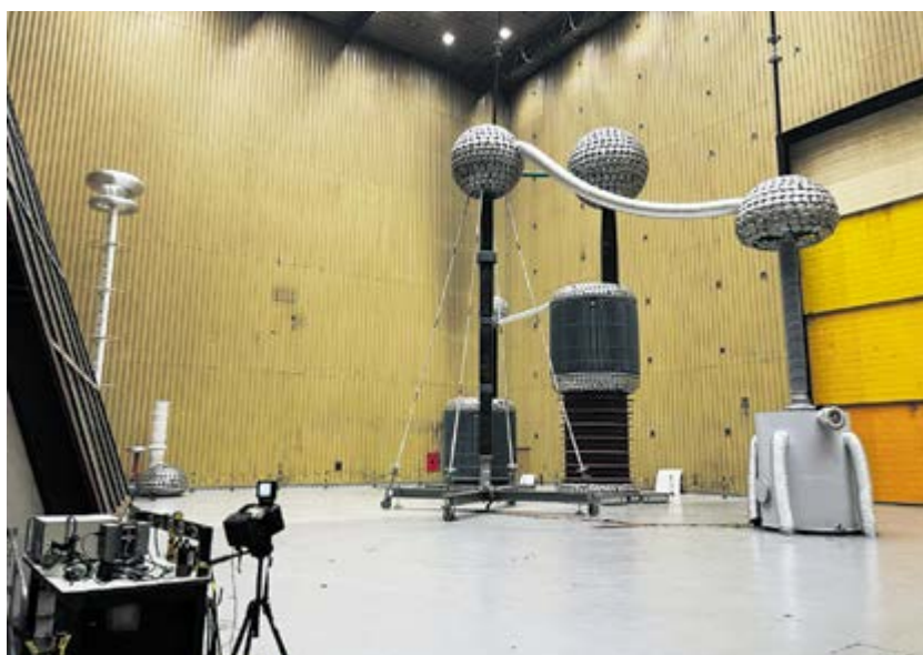
↓ Трансформаторный ввод «Изолятор» на напряжение 600 кВ с RIP-изоляцияей в имитационном баке на испытаниях (справа)
