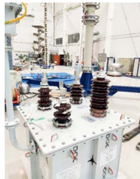
⚡ Испытания ввода 110 кВ с RIN-изоляцией в криостате на заводе «Изолятор»
