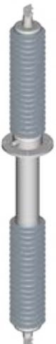
Линейные вводы «воздух — воздух» Напряжение: 66–220 кВ Ток: 2000–4000 А Изоляция: RIP или RIN
