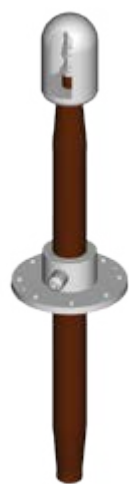
Вводы «масло — масло» для кабельного подключения трансформаторов Напряжение: 66–500 кВ Ток: 630–2000 А Изоляция: RIP или RIN
