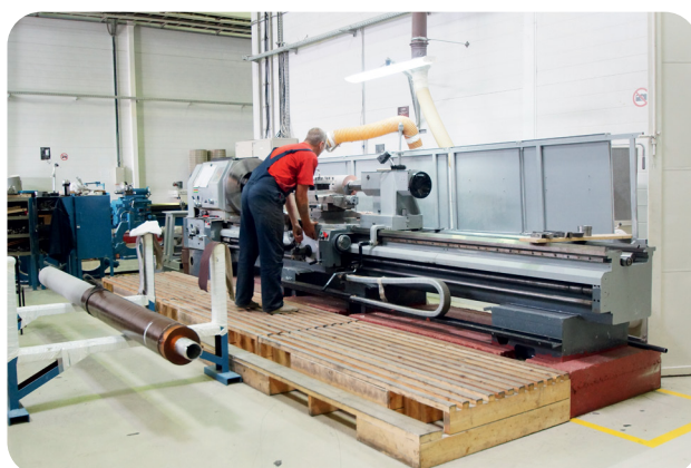
Рис. 15. Механическая обработка изоляционного остова
