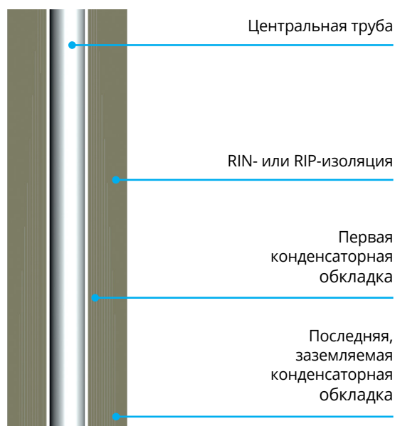
Рис. 5. Внутренняя твердая изоляция конденсаторного типа
