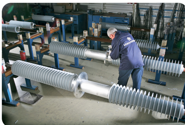
Рис. 17. Вводы 110 кВ с отлитой полимерной внешней изоляцией
