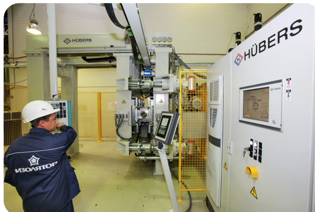
Рис. 16. Изготовление внешней полимерной изоляции на литьевой кокильной машине
