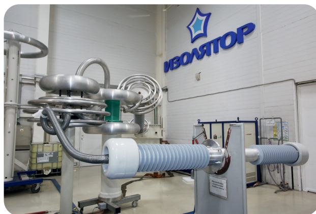
Рис. 20. Электрические испытания ввода 220 кВ
