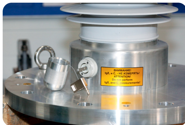
Рис. 12. Измерительный вывод со снятыми колпаком и пружинным мультиконтактом
