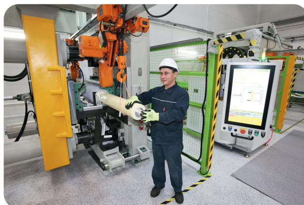
Рис. 21. Изготовление внешней полимерной изоляции на литьевой кокильной машине
