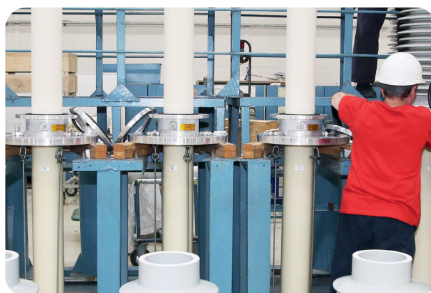
Рис. 22. Сборка вводов 110 кВ с фарфоровой внешней изоляцией
