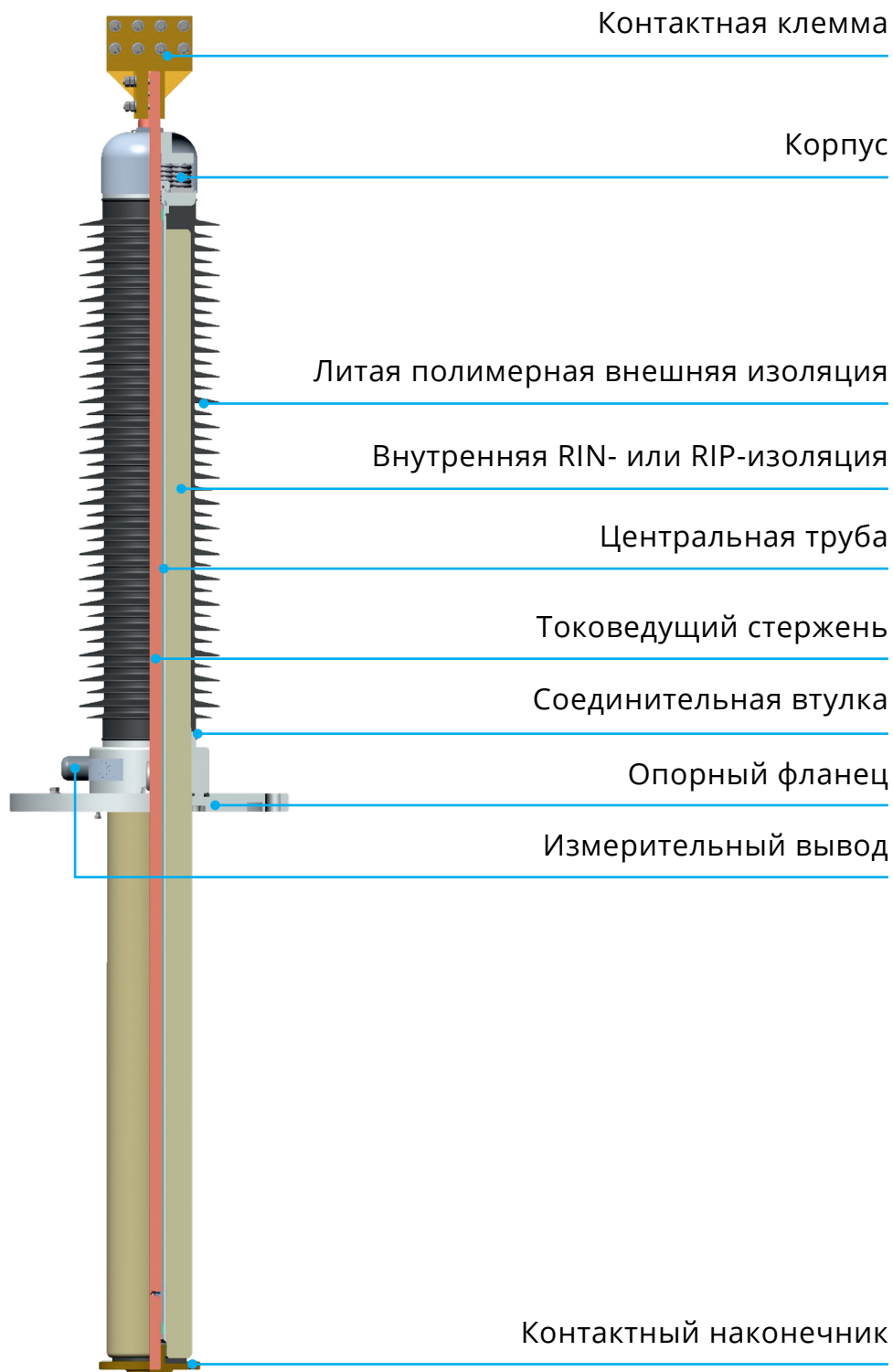
Рис. 1. Ввод класса напряжения 110 кВ с литой полимерной внешней изоляцией
