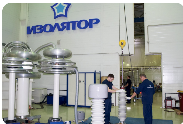
Рис. 24. Электрические испытания вводов 110 кВ
