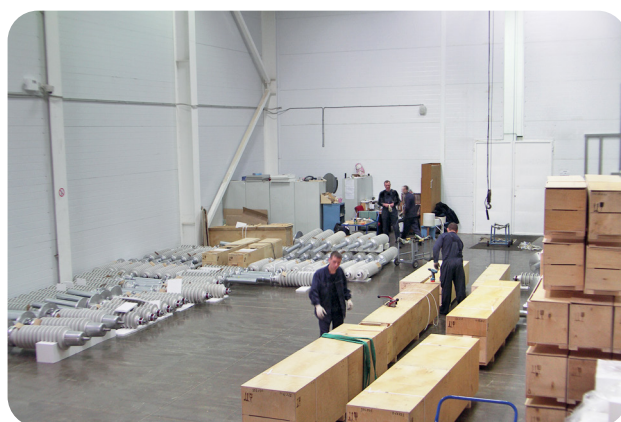
Рис. 25. Упаковка вводов 35 и 110 кВ в транспортную тару
