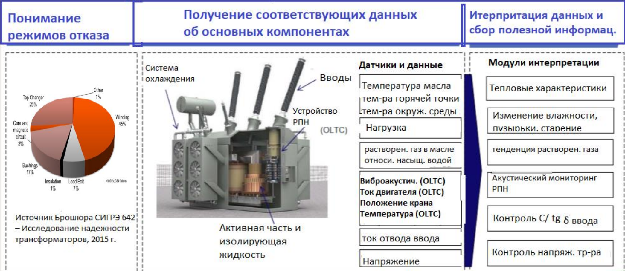
Рис: Виды отказов и задействованные компоненты, источники данных и модули мониторинга
