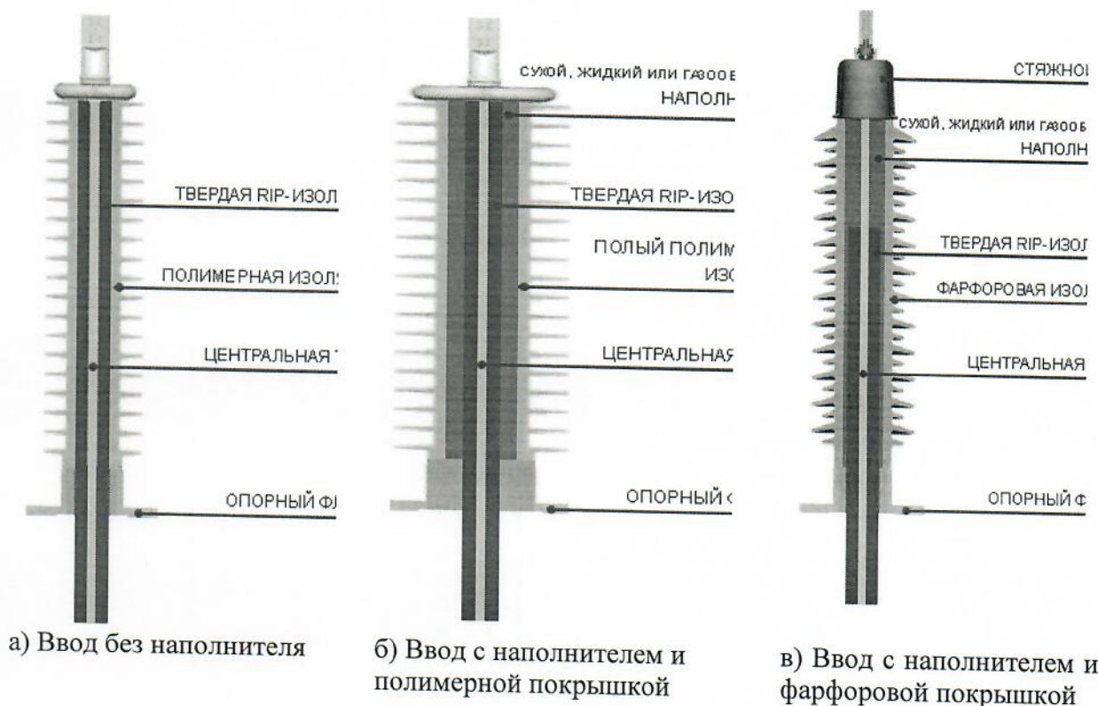
Рисунок 4. Конструкция внешней изоляции высоковольтных вводов
