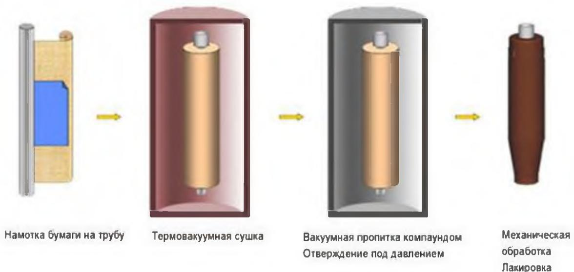
Рисунок 1. RIP-изоляция высоковольтного ввода
