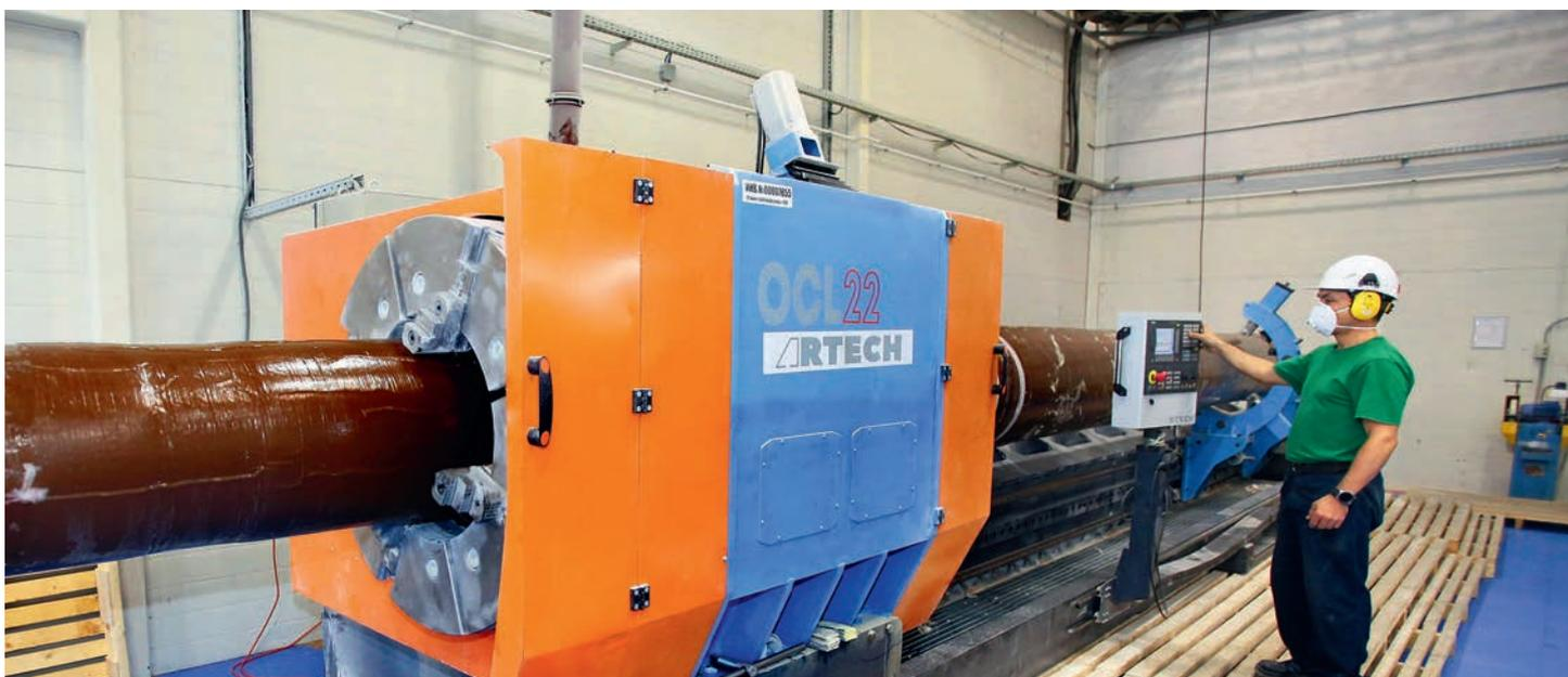
Механическая обработка заготовки внутренней изоляции ввода 1150 кВ на токарном станке с числовым программным управлением для придания изоляции требуемой геометрической формы
