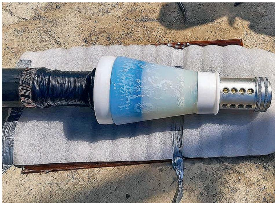
Кабельный ввод «Изолятор-АКС» ИКВ-252 на испытаниях
