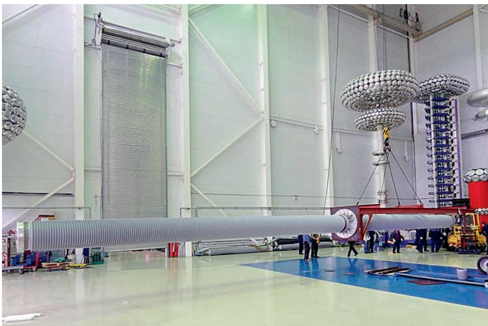
Линейный ввод  $\pm 820$  кВ постоянного тока в испытательном центре Производственного комплекса «Изолятор»
