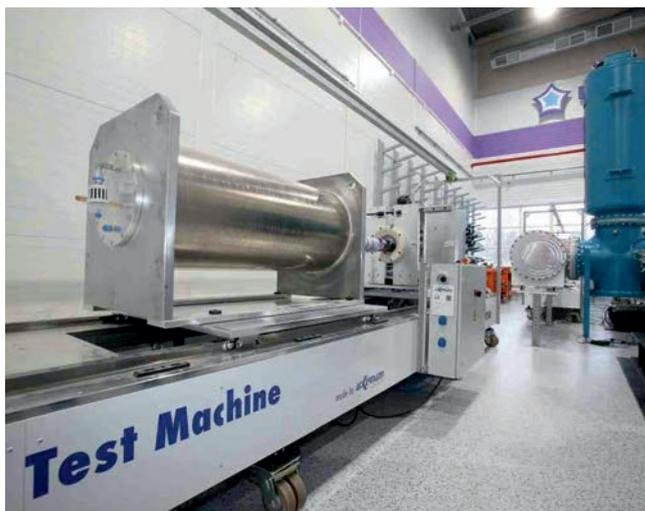
Стенд для испытаний арматуры на классы напряжения 110-220 кВ
