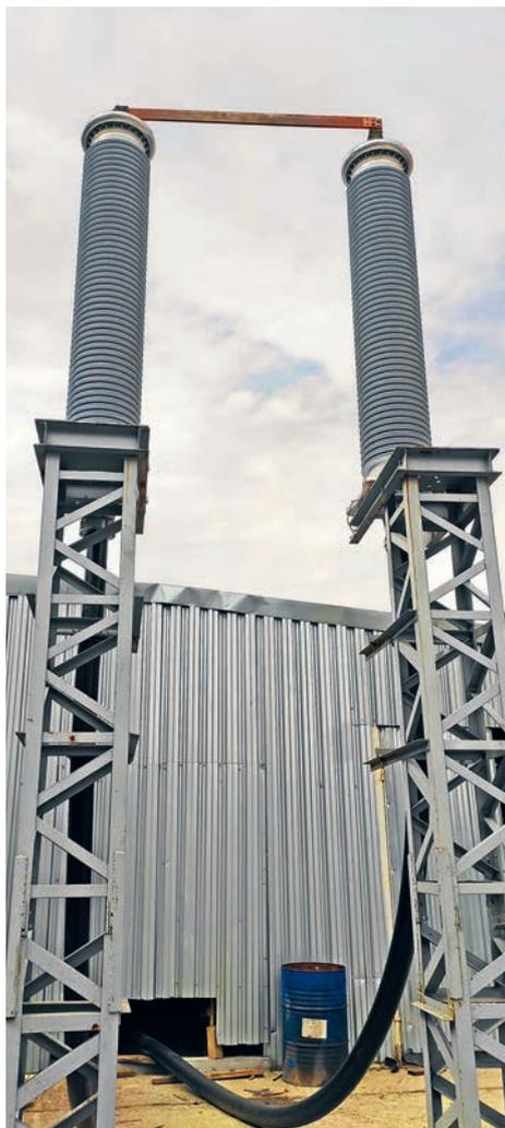
Предквалификационные испытания концевых кабельных муфт «Изолятор-АКС» ИКМ-252 в испытательном центре Всероссийского научно-исследовательского, проектно-конструкторского и технологического института кабельной промышленности
