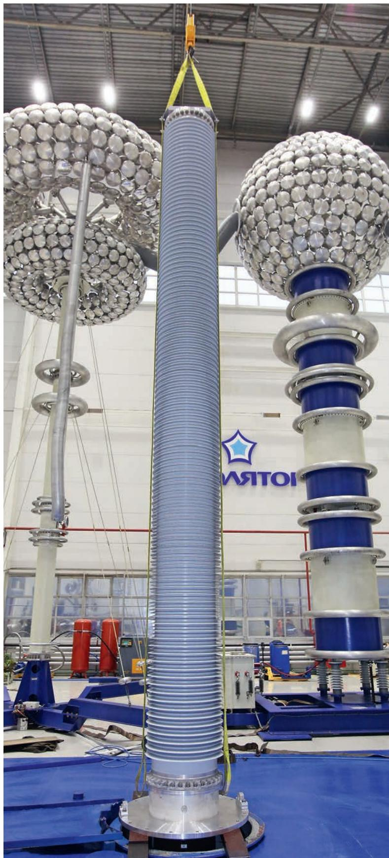
Установка ввода на испытательный бак для проведения приемочных испытаний
