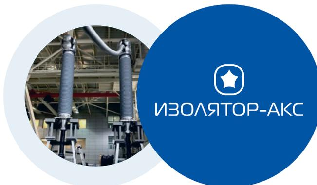
Завод «Изолятор-АКС» проектирует и производит высоковольтную кабельную арматуру на классы напряжения от 110 до 220 кВ для сечения кабеля от 185 до 2500 мм<sup>2</sup> — новое направление деятельности Группы компаний «Изолятор».
