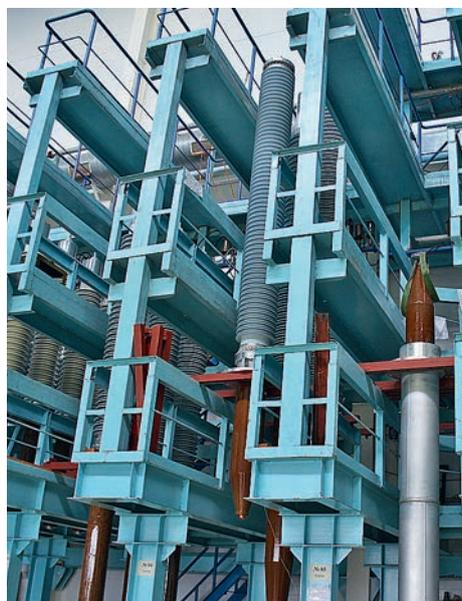
Высоковольтные вводы на технологических стойках сборочного цеха компании «Изолятор»
