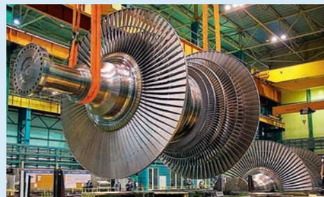
Сборка головного образца первой тихоходной турбины мощностью свыше 1250 МВт на Ленинградском металлургическом заводе, входящем в состав компании «Силовые машины» (фото: «Силовые машины»)
