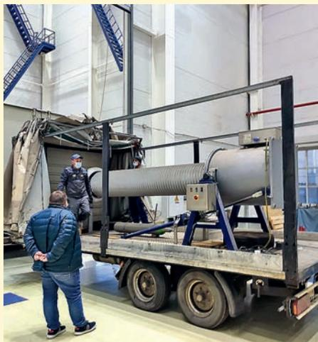
Эталонный мобильный трансформатор напряжения 500 кВ, доставленный в испытательный центр компании «Изолятор» для проверки по договору со Всероссийским научно-исследовательским институтом метрологической службы
