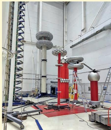
Проверка поверочного делителя класса напряжения 750 кВ в испытательном центре компании «Изолятор»
