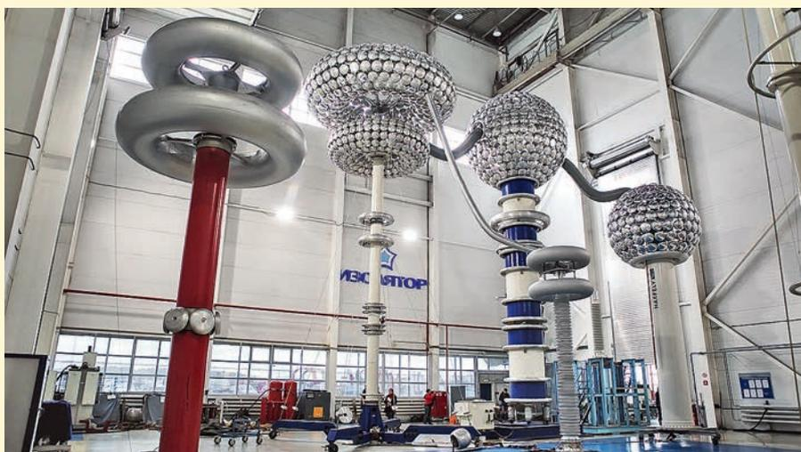
Испытания ввода на напряжение 420 кВ перед отгрузкой
