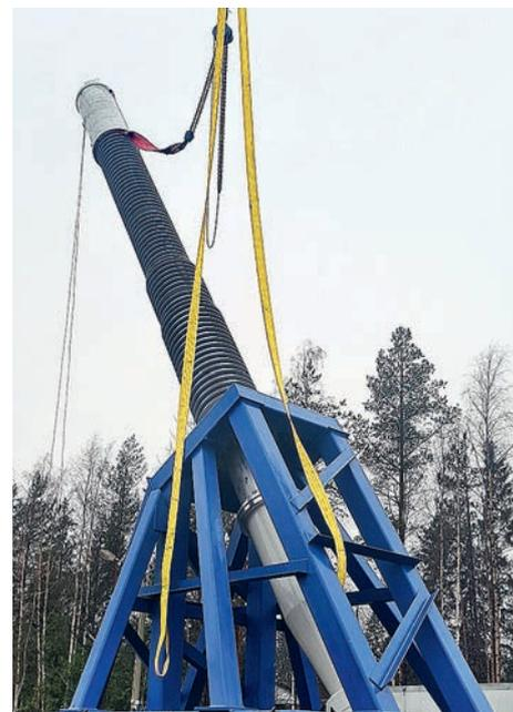
Трансформаторный ввод «Изолятор» класса напряжения 750 кВ на сейсмоплатформе Центра комплексно-сейсмических испытаний в Ленинградской области
