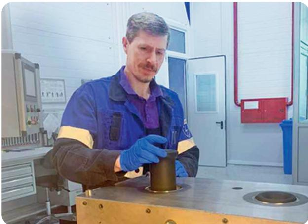
Извлечение дефлектора на 110 кВ из пресс-формы
