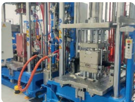
Литьевая машина для производства стресс-конусов и управляющих тел муфт
