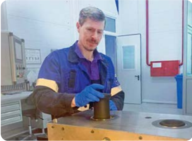
Извлечение дефлектора на 110 кВ из пресс-формы
