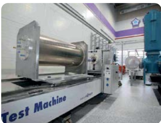
Стенд для испытаний арматуры на классы напряжения 110-500 кВ
