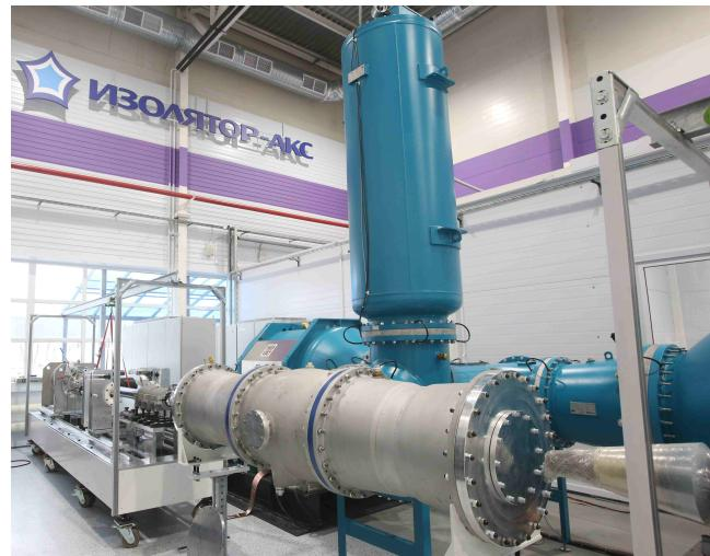
Лаборатория для приемно-сдаточных испытаний кабельной арматуры
