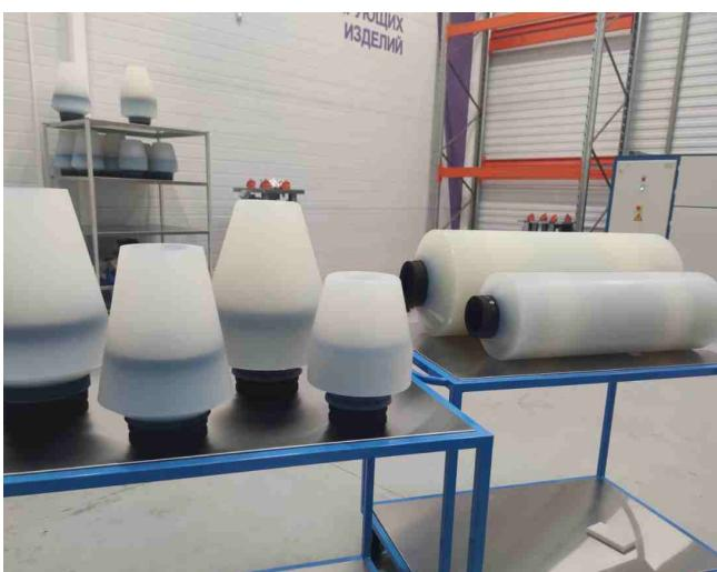
Стресс-конусы и управляющие тела концевых и соединительных муфт и кабельных вводов
