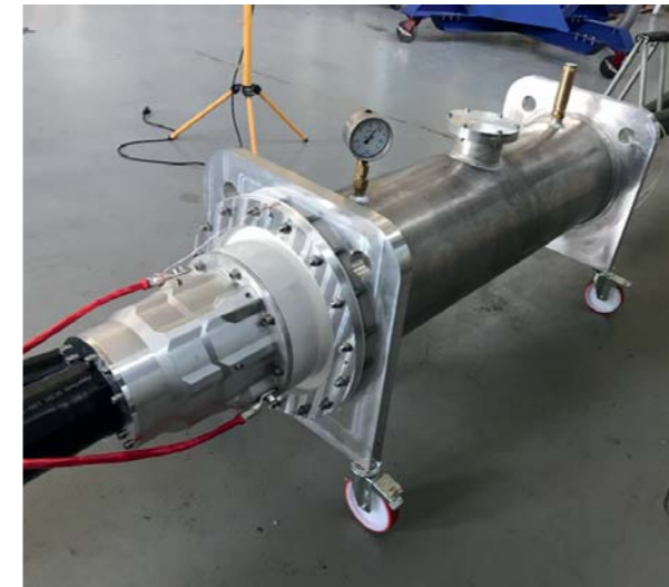
Штекерные муфты класса напряжения 220 кВ в элегазовой испытательной системе
