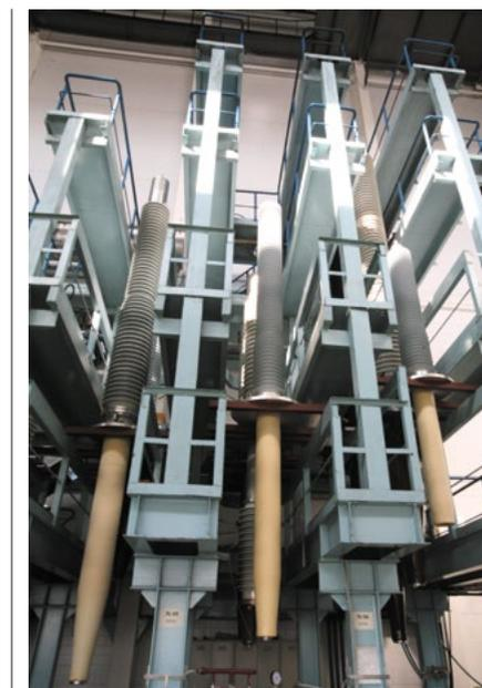
Аттестационная комиссия Группы «Россети» выдала заключение о соответствии высоковольтных вводов «Изолятор» с внутренней RIN-изоляцией техническим требованиям Группы «Россети» для применения на объектах дочерних и зависимых обществ. Аттестованы вводы для трансформаторов на наибольшее рабочее напряжение до 550 кВ включительно, вводы для выключателей на наибольшее рабочее напряжение от 40,5 до 252 кВ включительно и линейные вводы на наибольшее рабочее напряжение от 73 до 252 кВ включительно.
