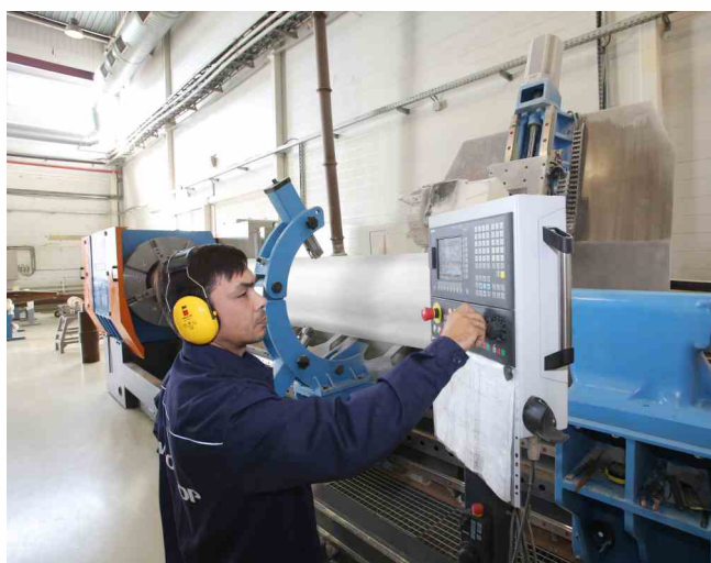
Рис.20 Токарная обработка изоляционного остова
