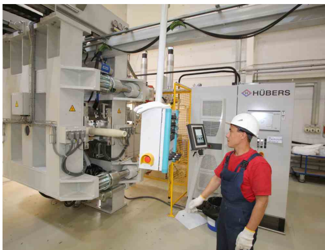
Рис.23 Автоматическое изготовление внешней полимерной изоляции
