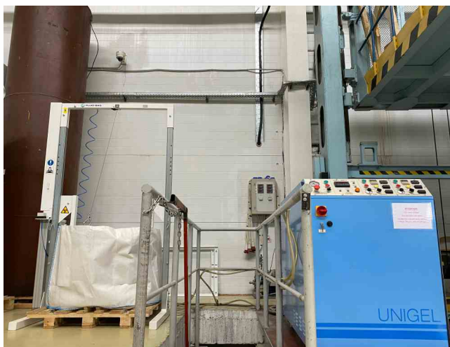
Рис.22 Установка для дегазации и дозирования компрессионного геля
