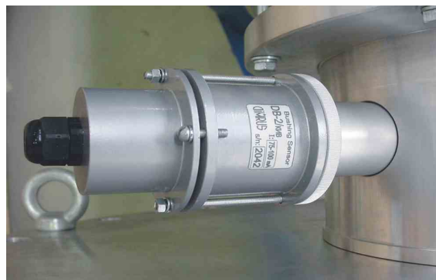
Рис.16 Датчик для защиты измерительного вывода
