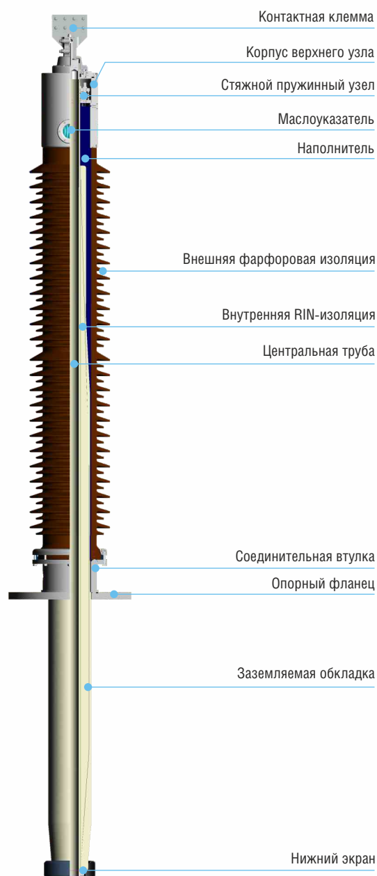
Рис.1 Ввод с фарфоровой внешней изоляцией
