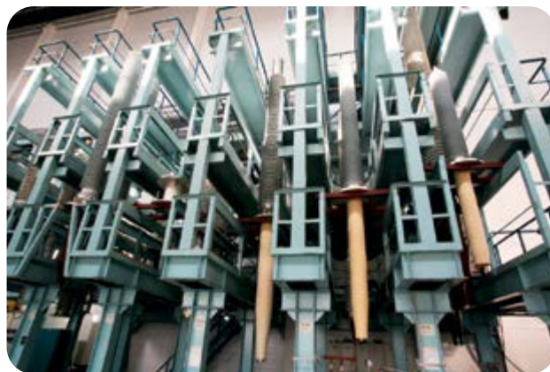
Рис. 25. Вводы 500, 330 и 220 кВ с различными видами внешней изоляции
