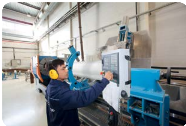
Рис. 24. Механическая обработка изоляционного остова
