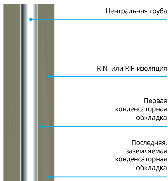
Рис. 5. Внутренняя твердая изоляция конденсаторного типа
