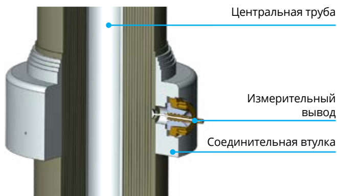
Рис. 6. Внутренняя изоляция в сборке с соединительной втулкой
