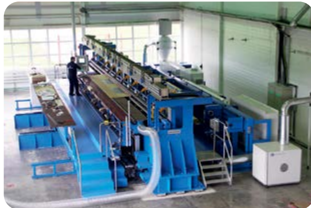
Рис. 22. Высокоавтоматизированный станок для намотки основной изоляции 220–1150 кВ
