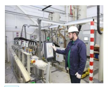
Рис.19 Вакуумная пропитка основной изоляции
