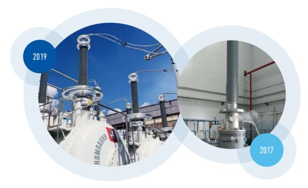
Впервые в России в Производственном комплексе «Изолятор» были успешно испытаны высоковольтные вводы, помещенные в криостат с жидким азотом. Специально разработанные вводы классов напряжения 110 и 220 кВ с RIN-изоляцией и емкостным регулированием электрического поля выдержали перепад температур от – 200 °С в нижней части до +10 °С в верхней точке.
