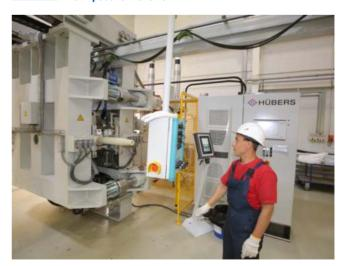
Автоматическое изготовление внешней полимерной изоляции
