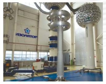
Рис.24 Злектрические испытания ввода 500 кВ с RIN-изоляцией в испытательном центре «Изолятор»
