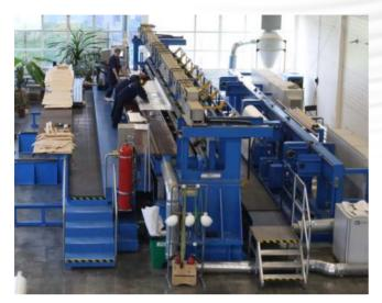
Рис.18 Высокоавтоматизированный станок для намотки основной изоляции 220-1150 кВ
