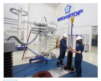
Рис.25 Электрические испытания вводов 110 кВ
