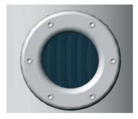
Рис.7 Нормальный уровень жидкого наполнителя
