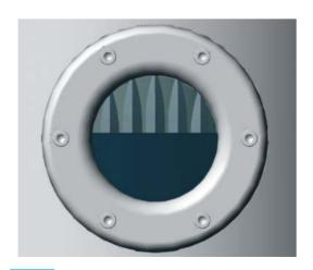
Рис.8 Пониженный уровень жидкого наполнителя
