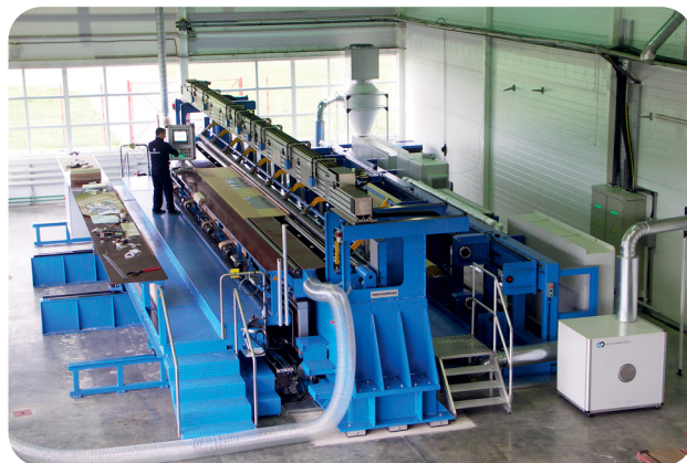
Рис. 22. Высокоавтоматизированный станок для намотки основной изоляции 220–1150 кВ
