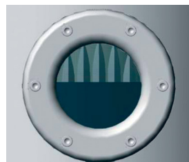
Рис. 12. Пониженный уровень жидкого наполнителя
