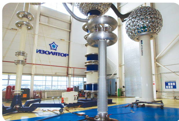
Рис. 28. Электрические испытания ввода 500 кВ в испытательном центре «Изолятор»
