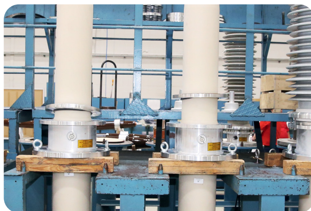
Рис. 27. Сборка вводов 110 кВ с фарфоровой внешней изоляцией
