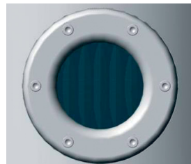
Рис. 11. Нормальный уровень жидкого наполнителя
