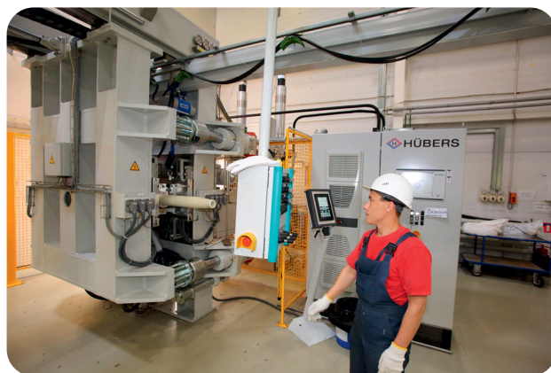
Рис. 26. Изготовление внешней полимерной изоляции на литьевой кокильной машине
