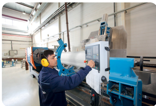
Рис. 24. Механическая обработка изоляционного остова
