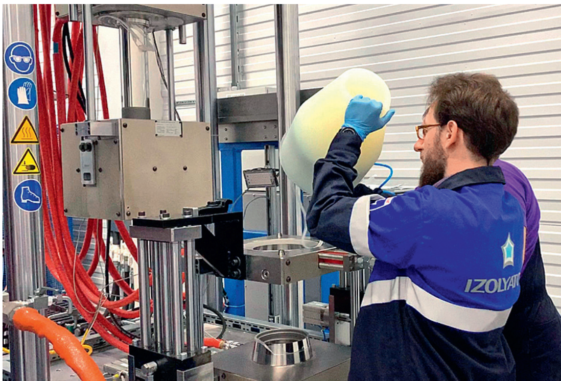
Производство стресс-конусов для концевых кабельных муфт на заводе «Изолятор-АКС»
