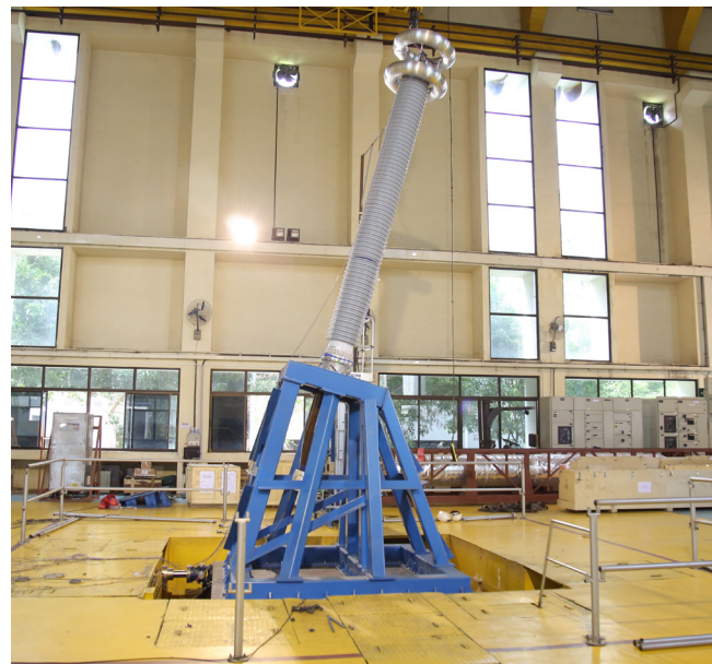
Сейсмические испытания ввода «Изолятор» 420 кВ / 3000 А в лаборатории Государственного научно-исследовательского института энергетики в Индии
