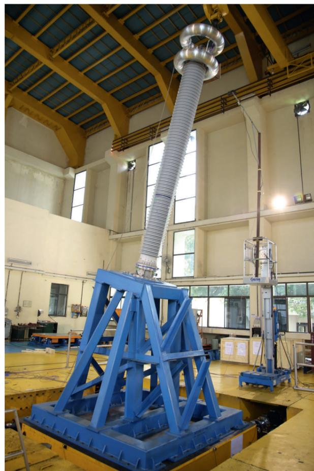
Сейсмические испытания ввода «Изолятор» 420 кВ / 3000 А в лаборатории Центрального научно-исследовательского института энергетики в Индии
