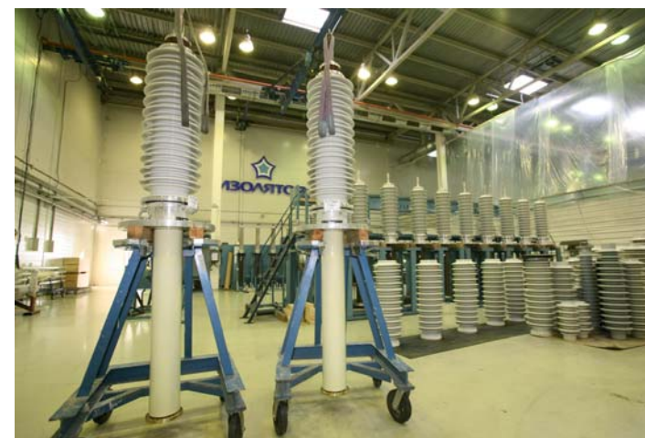
Сборка вводов с RIN-изоляцией для масляных выключателей
