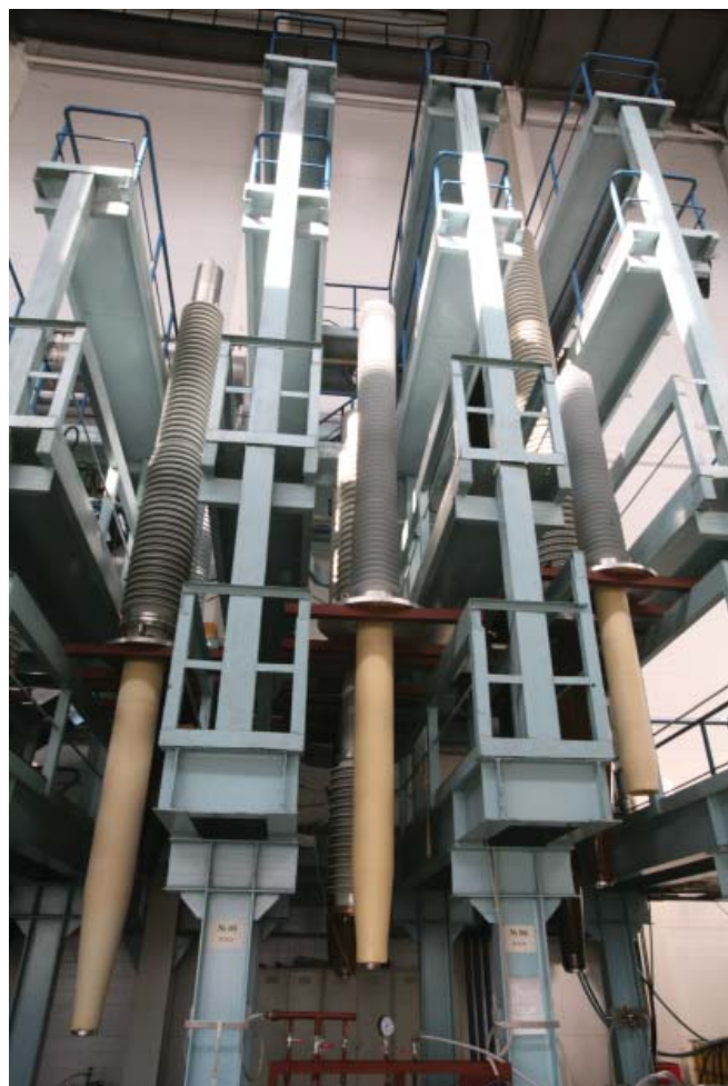
Рис. 1 Сборка высоковольтных вводов с RIN-изоляцией на заводе «Изолятор»
