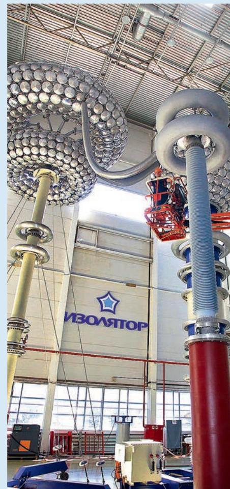
Испытания вводов «масло — элегаз» класса напряжения 500 кВ на заводе «Изолятор»
