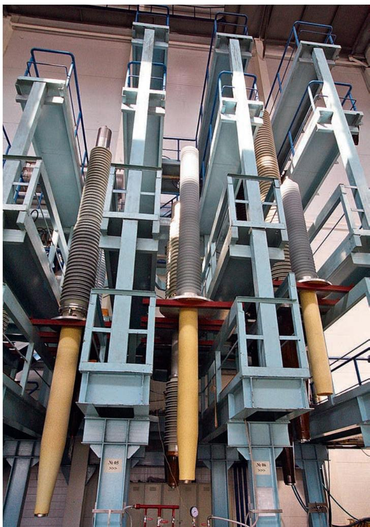
Вводы 500, 330 и 220 кВ с RIN-изоляцией на технологических стойках сборочного цеха завода «Изолятор»
