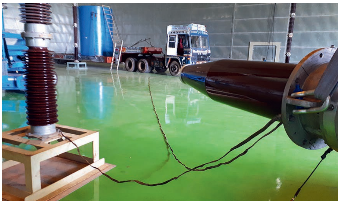
◀ Измерение параметров вводов до импульсных испытаний
