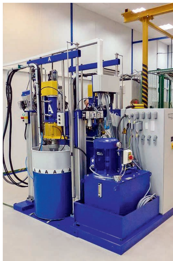
Дозировочное устройство Dokosil, входящее в комплект оборудования Vogel
