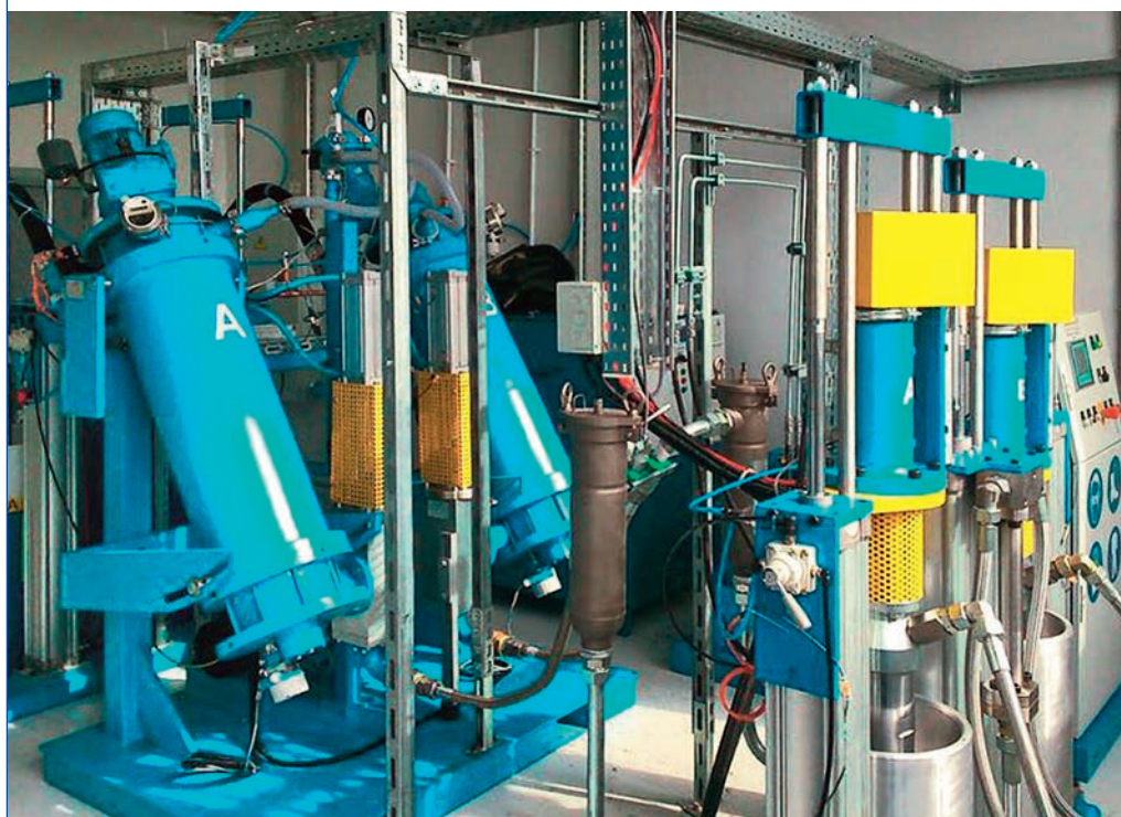
Блок дегазации силикона On the fly производства компании Vogel
