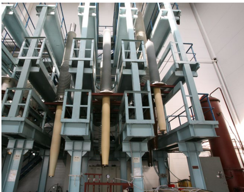
Вводы с RIN-изоляцией в сборочном цехе завода «Изолятор»
