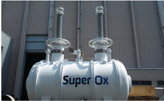
Рис. 1 Первая фаза сверхпроводникового ограничителя тока класса напряжения 220 кВ, оборудованная вводами «Изолятор», в испытательном центре института KERI (Южная Корея)
