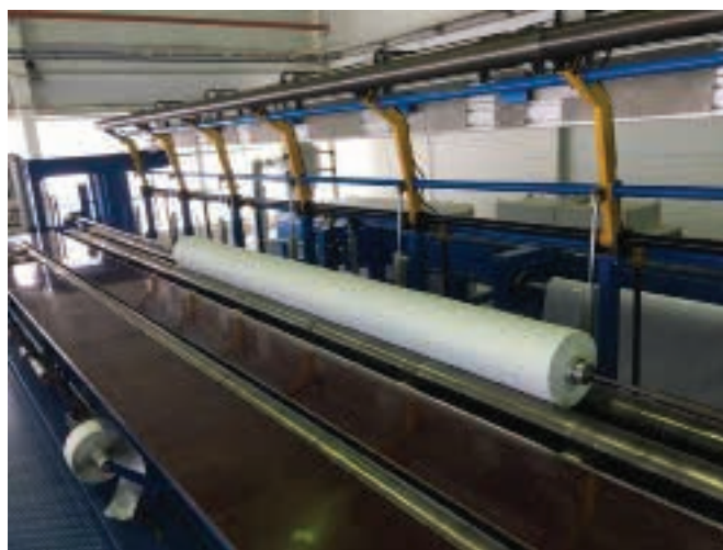
Рис. 4. Изоляционный остов с RIN-изоляцией на намоточном станке TUBOLY
