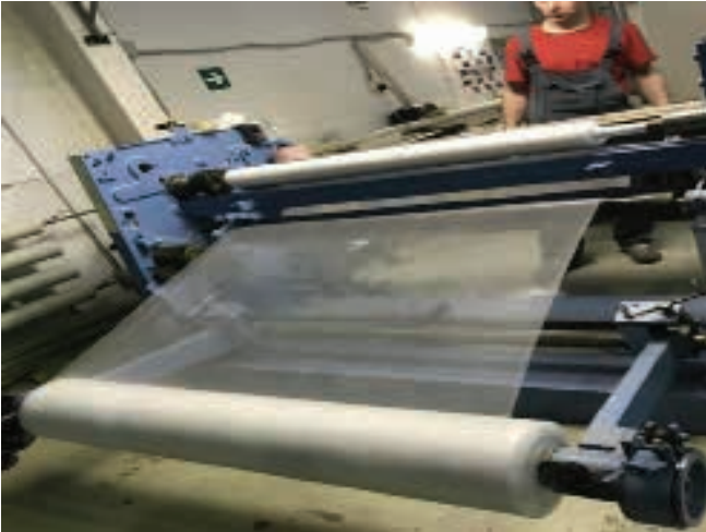
Рис. 9. Намотка изоляции с использованием полимерной сетки
