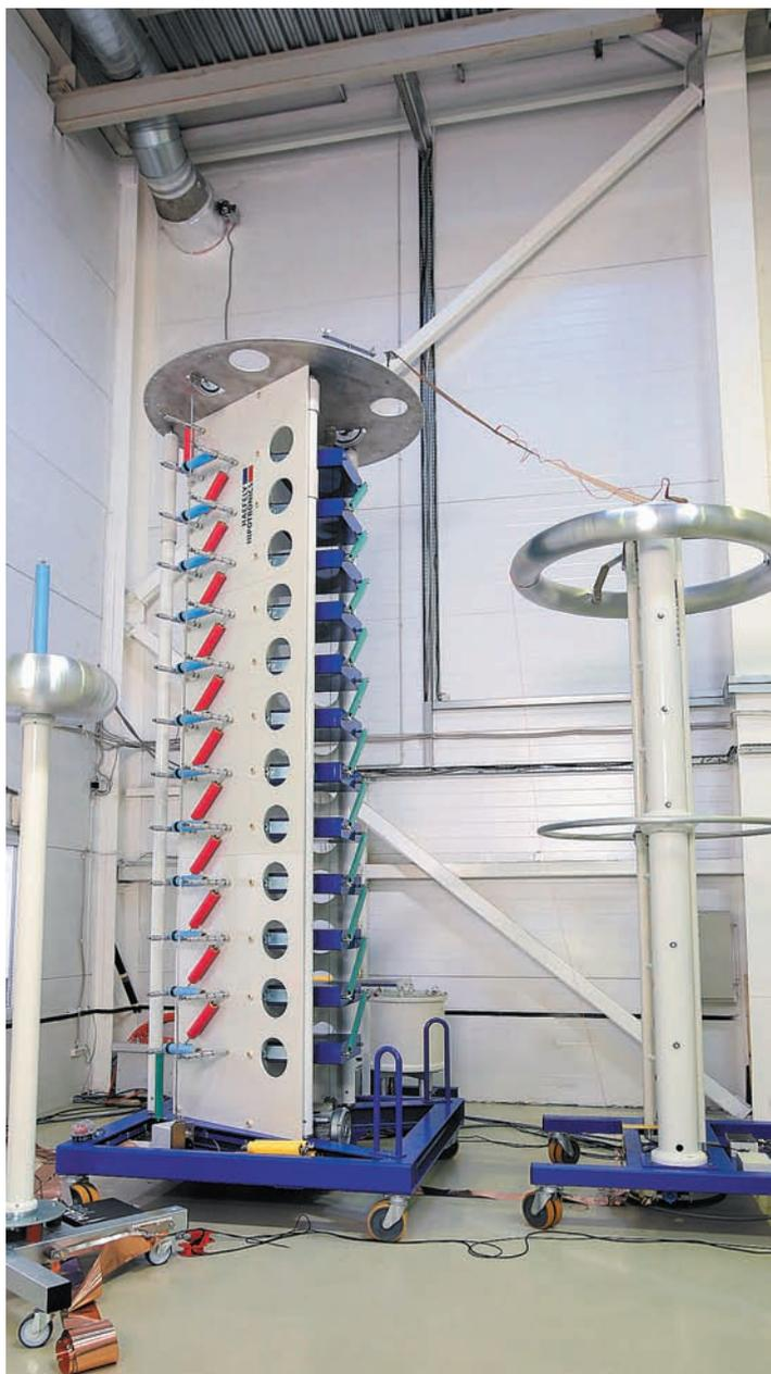
Генератор импульсного напряжения 1200 кВ, установленный в испытательном центре компании «Изолятор»
