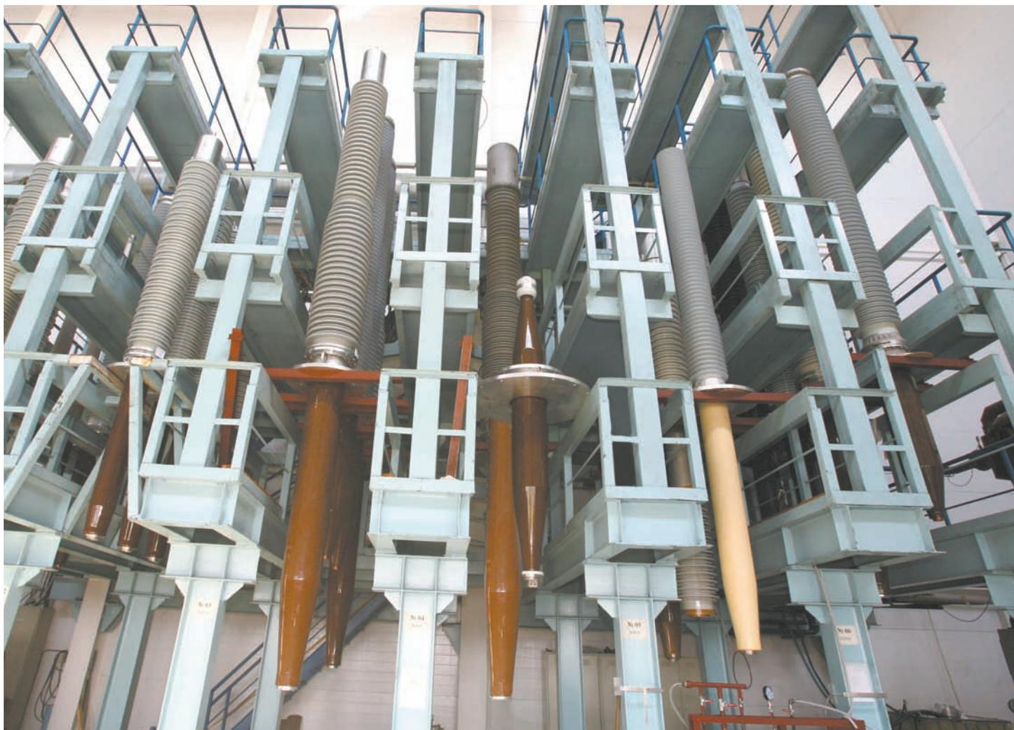
Высоковольтные вводы на технологических стойках в сборочном цехе завода «Изолятор»
