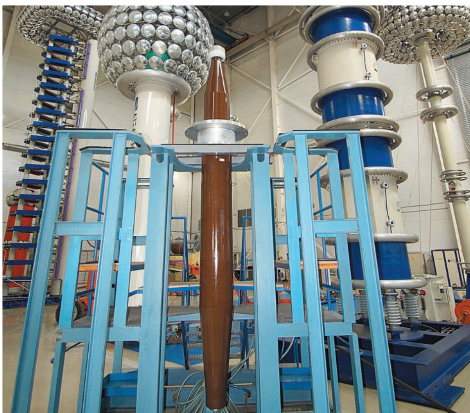
Ввод «элегаз-масло» 500 кВ после успешных испытаний
