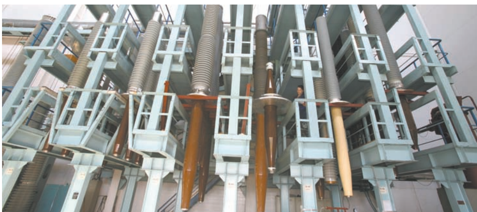
Высоковольтные вводы на технологических стойках сборочного цеха завода «Изолятор»
