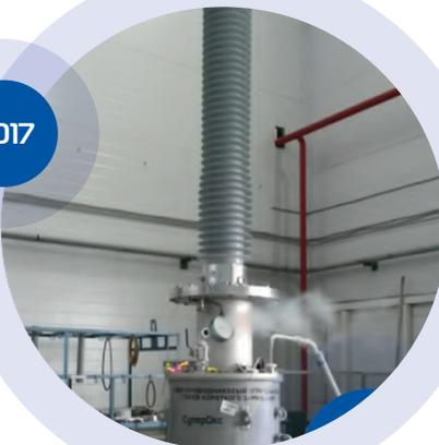
Впервые в России в производственном комплексе «Изолятор» были успешно испытаны высоковольтные вводы, помещенные в криостат с жидким азотом. Специально разработанные вводы классов напряжения 110 и 220 кВ с RIN-изоляцией и емкостным регулированием электрического поля выдержали перепад температур от  $-200\text{ }^{\circ}\text{C}$  в нижней части до  $+10\text{ }^{\circ}\text{C}$  в верхней точке.
