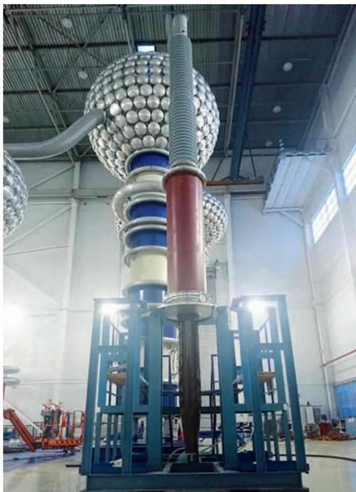
Испытания на заводе «Изолятор» ввода «масло–элегаз» на класс напряжения 500 кВ
