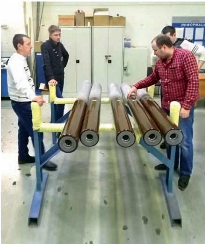
Специалисты «Кубаньэнерго» знакомятся с технологией изготовления внутренней твердой RIP-изоляции высоковольтных вводов. Занятие ведет Дмитрий Машинистов
