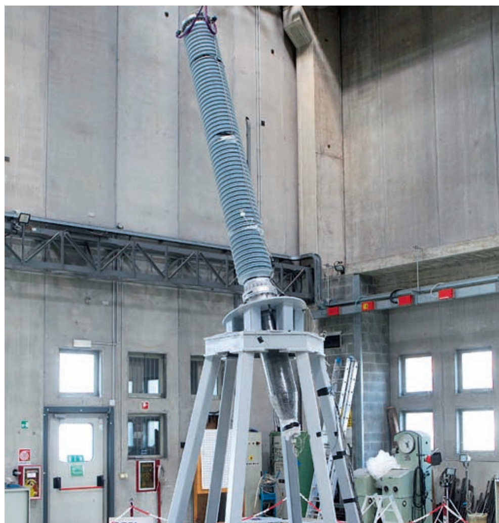
Высоковольтный ввод «Изолятор» на испытательном стенде в CESI S. p. A.
