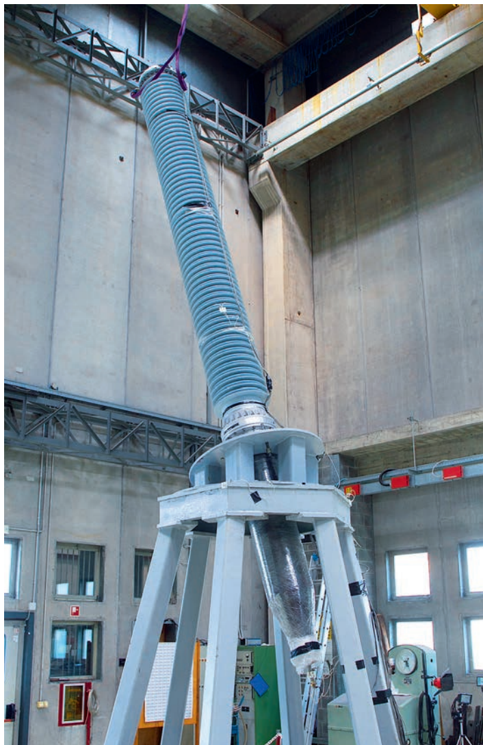
Ввод готов к испытаниям
