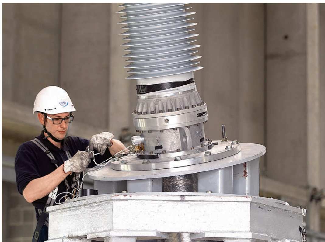
Подсоединение измерительного оборудования
