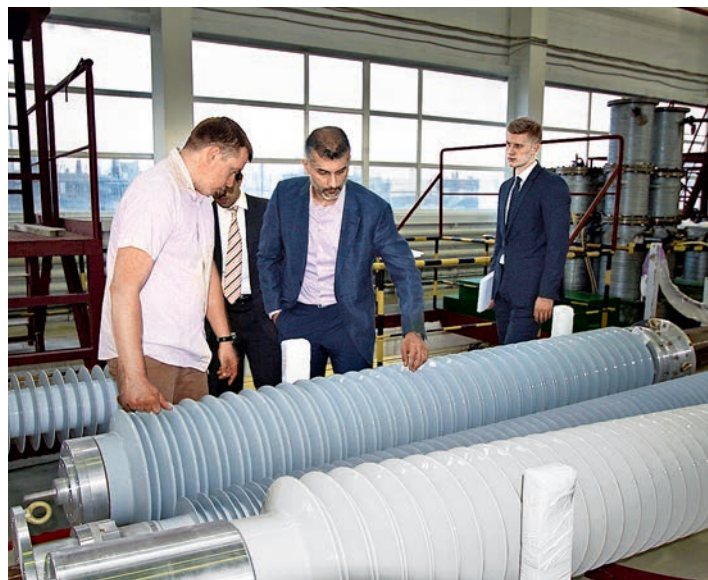
На участке сборки вводов 220–1150 кВ
