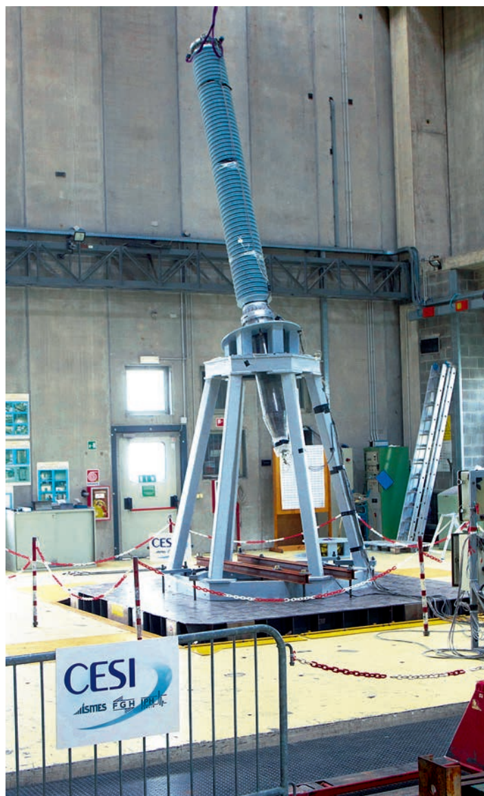
Процесс испытаний на сейсмостойкость
