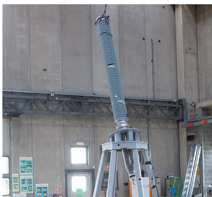
Ввод «Изолятор» на испытательном стенде
