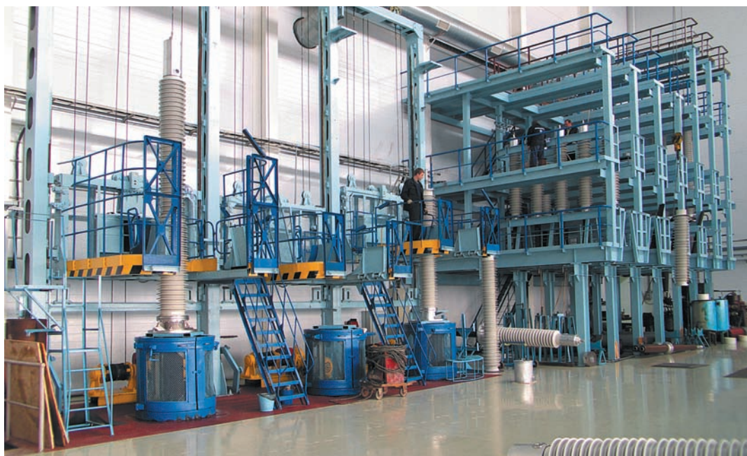
Участок сборки вводов на классы напряжения 220–1150 кВ
