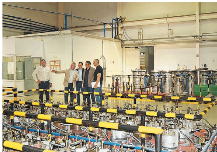
На участке пропитки и полимеризации внутренней изоляции вводов
