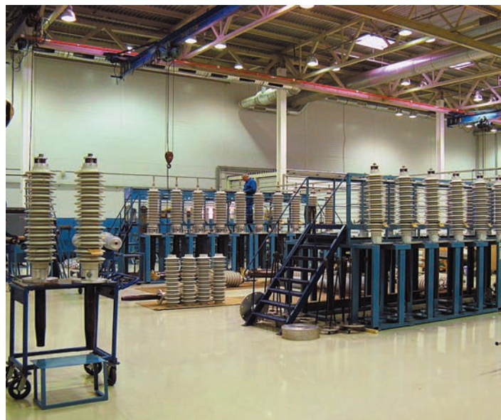
Сборка вводов 110 кВ на заводе «Изолятор»
