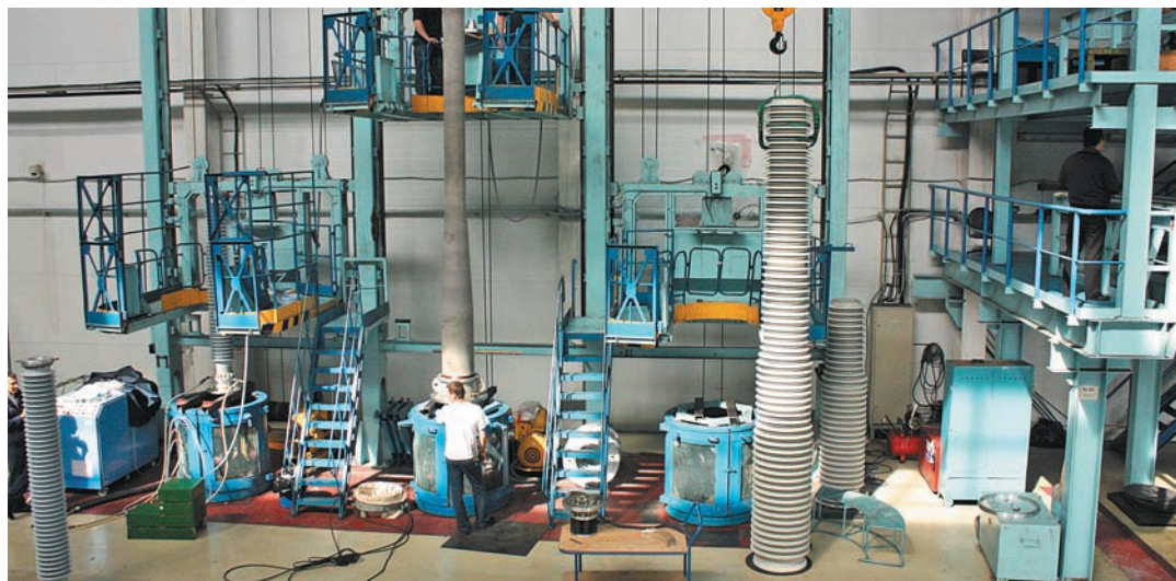
Сборка трансформаторного ввода 750 кВ с RIP-изоляцией на заводе «Изолятор»
