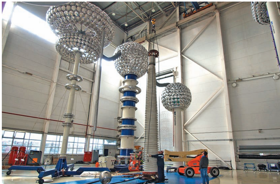
Испытания ввода класса напряжения 1150 кВ на заводе «Изолятор»
