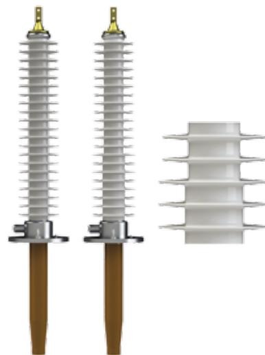
Недавно мы провели модернизацию вводов 110 кВ 800 А для трансформаторов с полимерной наружной изоляцией. Для увеличения механической прочности вводов и дополнительной защиты внутренней изоляции от увлажнения был увеличен диаметр средней части, что позволило придать вводу дополнительный запас прочности, увеличить его надежность и ресурс.
