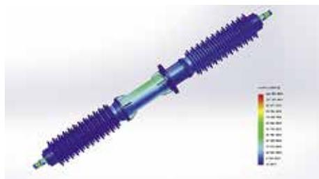
После проведения всех необходимых расчетов начинается разработка трехмерной модели ввода и чертежей для изготовления всех необходимых деталей и узлов.
