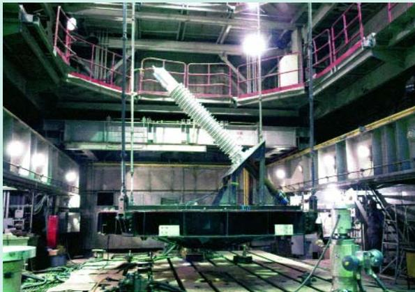
Рис. 10. Общий вид испытаний ввода ГКТII-45-220/2000 O1 на установке ЭГВУ
