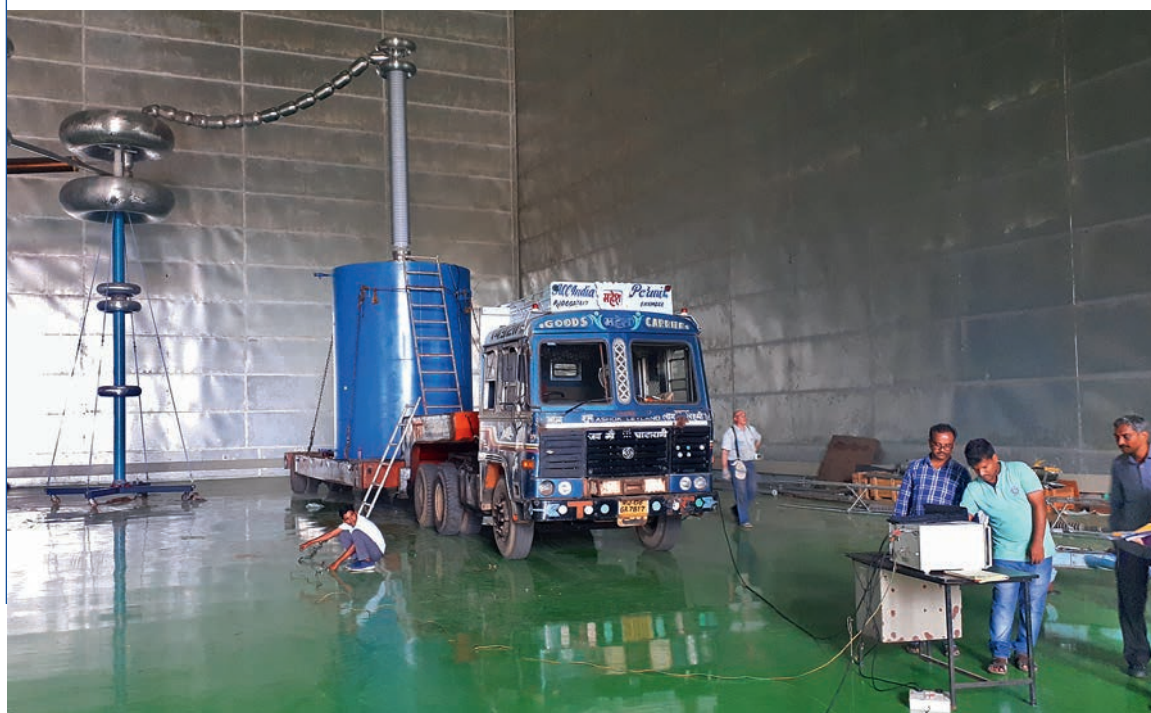
◀ Измерение параметров вводов до импульсных испытаний
