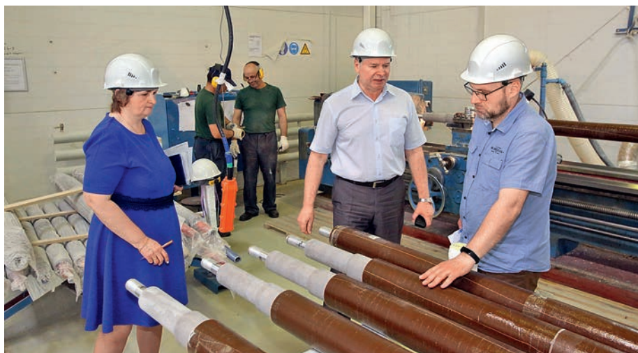
Ведущий эксперт Агентства надзора за качеством Андрей Брижанкин (справа) проводит инспекционный контроль сертифицированного производства вводов «Изолятор» для АЭС
