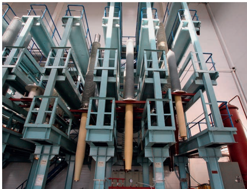
Вводы с RIN-изоляцией на технологических стойках сборочного цеха компании «Изолятор»
