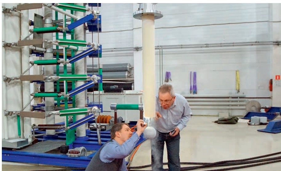
Анализ результатов криогенных испытаний ввода с RIN-изоляцией в компании «Изолятор»
