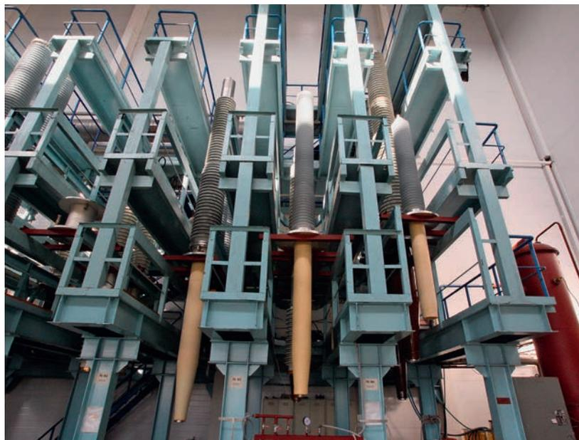
Вводы с RIN-изоляцией на технологических стойках сборочного цеха компании «Изолятор»
