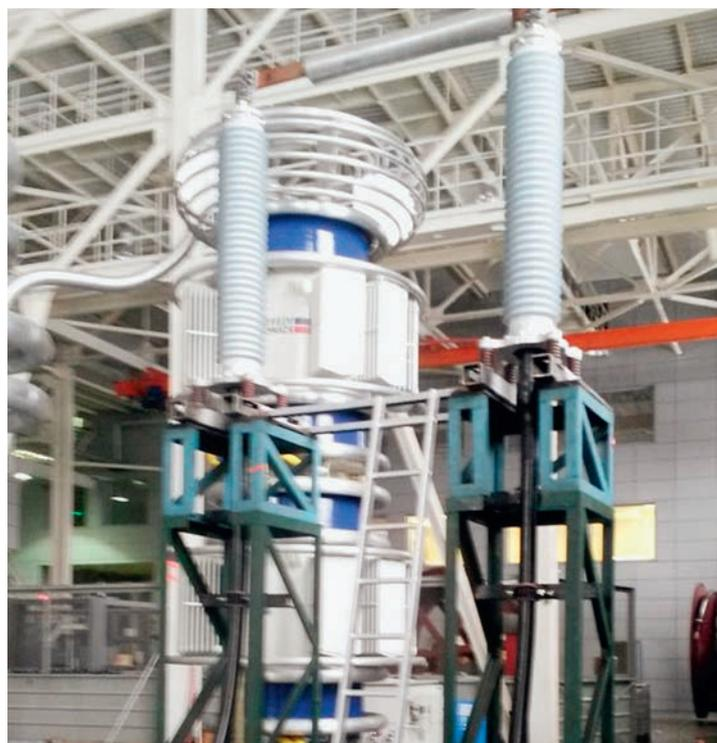
Концевая кабельная арматура в испытательной лаборатории
