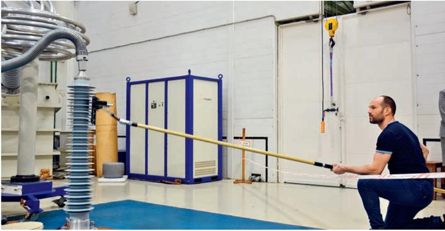
Функциональные испытания канадского тестера Positron в испытательном центре компании «Изолятор»
