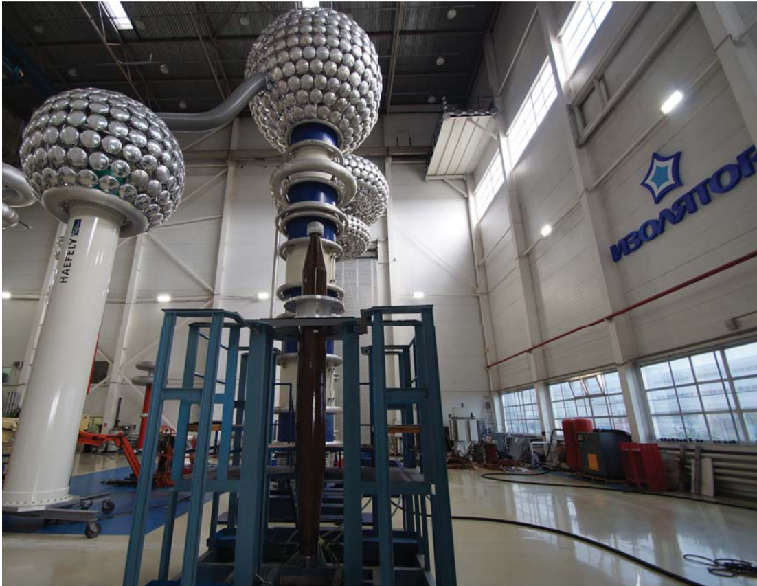
Ввод масло-элегаз 500 кВ в испытательном зале компании «Изолятор»
