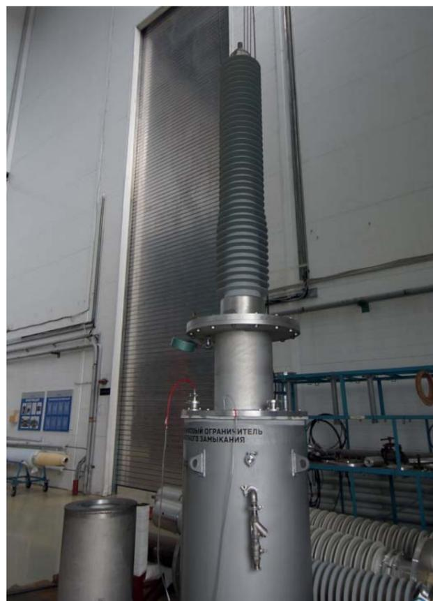
Ввод 220 кВ в криостате во время испытаний на заводе «Изолятор»
