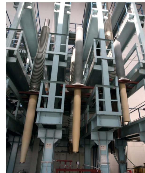
Рис. 1. Вводы с RIN-изоляцией на сборочном стенде
