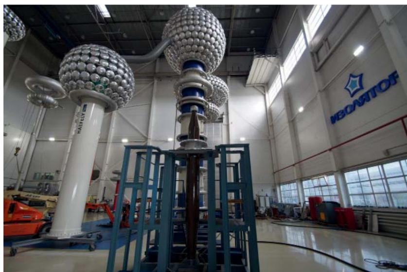
Ввод «масло-элегаз» с RIP-изоляцией в испытательном центре завода «Изолятор»
