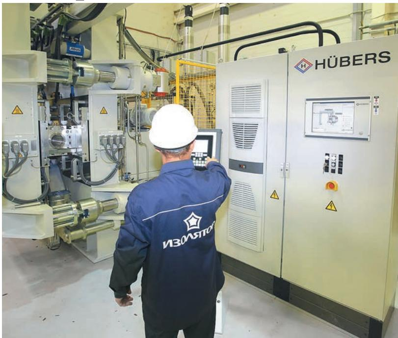
Новое оборудование для изготовления внешней полимерной изоляции вводов на заводе «Изолятор»
