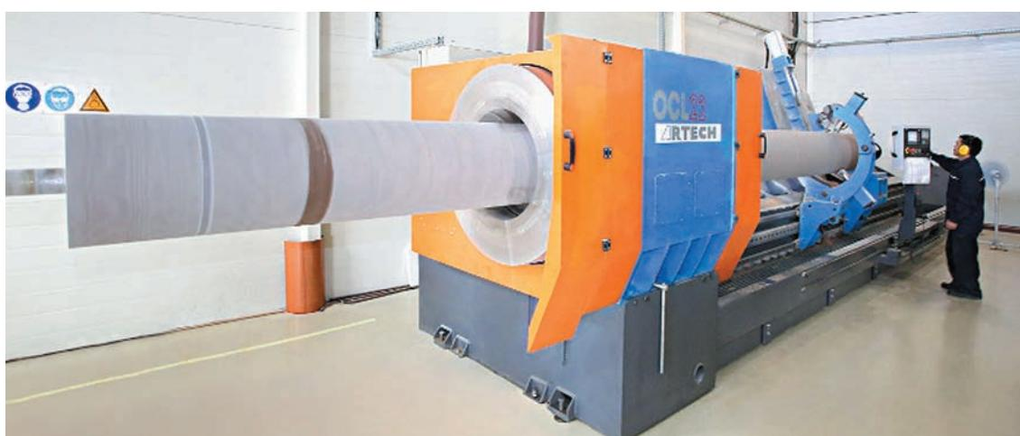
◀ Новый станок для механической обработки изоляции 500–750 кВ в цехе изготовления изоляции завода «Изолятор»
