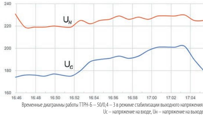
Временные диаграммы работы ТТРН-Б – 50/0,4 – 3 в режиме стабилизации выходного напряжения.
