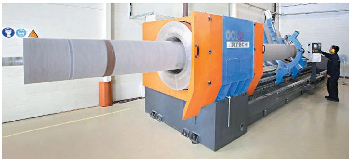
◀ Новый станок для механической обработки изоляции 500–750 кВ в цехе изготовления изоляции завода «Изолятор»
