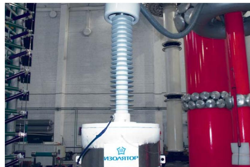
Испытания ввода 110 кВ с RIN-изоляцией в криостате на заводе «Изолятор»
