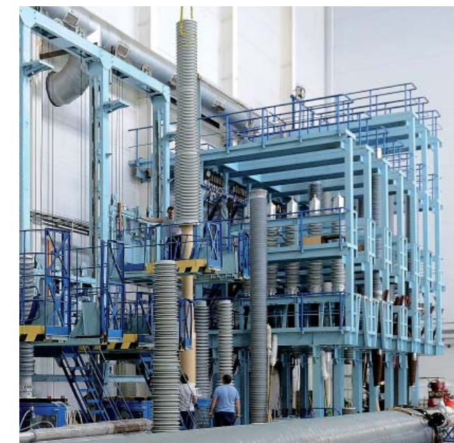
Сборочный цех высоковольтных вводов завода «Изолятор»
